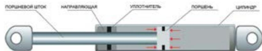
**Как устроена газовая пружина?** Газовая пружина состоит из герметичного цилиндра и свободно перемещающего штока с поршнем. Толкающее усилие возникает потому, что площадь поршня со стороны штока меньше, чем с обратной стороны. Дополнительные элементы — уплотнители, масло и др. — нужны, чтобы обеспечить плавность перемещения поршня и герметичность всего механизма.
