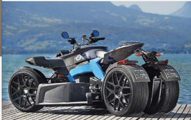
Трицикл оснащен двумя электромоторами мощностью 30 кВт каждый
