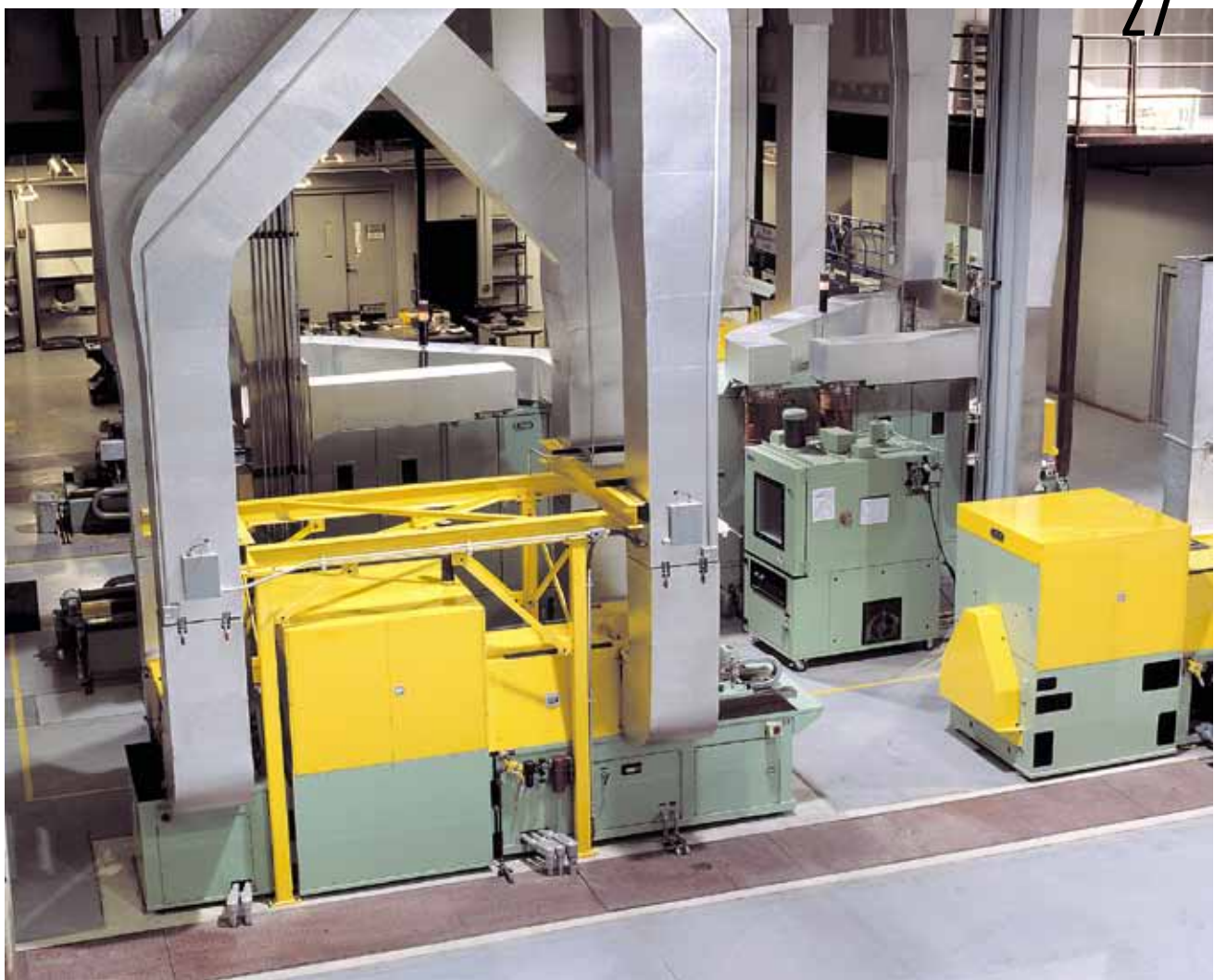
В техническом центре АКЕВОНО собрано 20 разных динамометров для тестирования колодок на шум, твердость и другие показатели
